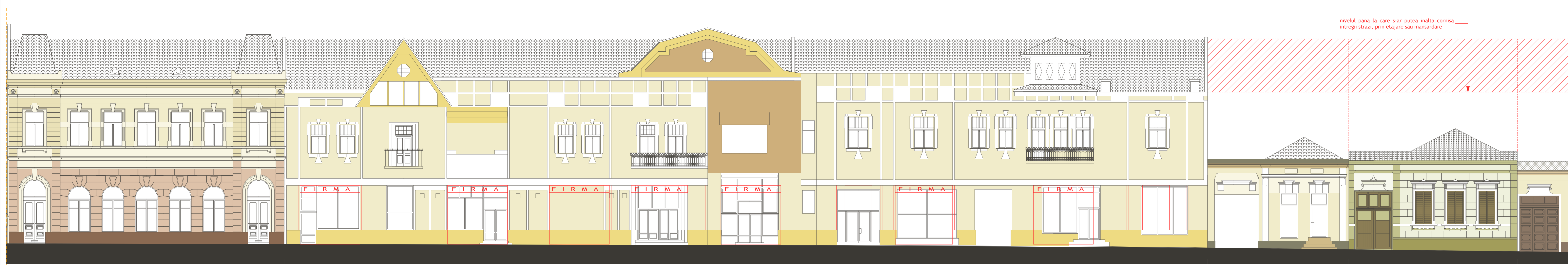
24. REABILITARE FATADE ISTORICE - GOLURI PENTRU USI, FERESTRE SI VITRINE ISTORICE - scara 1:100
