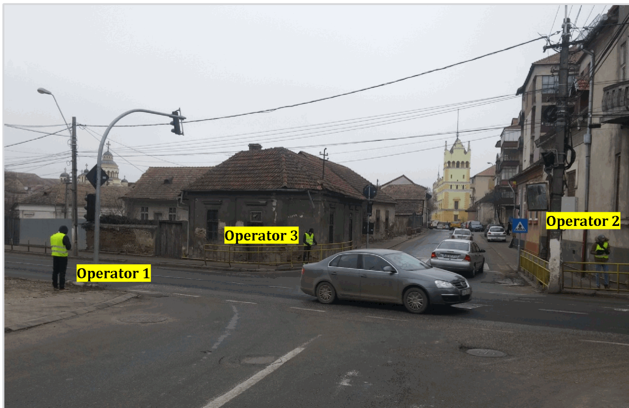
Figura 3.16. Anchetă de trafic în intersecție, Post 11 (exemplificare).
