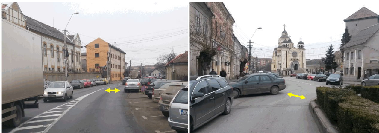
Figura 4.2. Situații de parcare neregulamentare cu consecințe asupra reducerii capacității de circulație și siguranței rutiere (Str. Morii, Piața Cuza Vodă).
